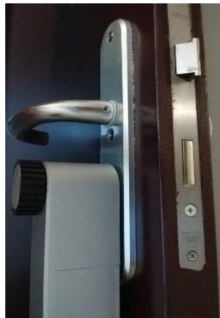
Figuur 4 Een slot met app (Telelock)
